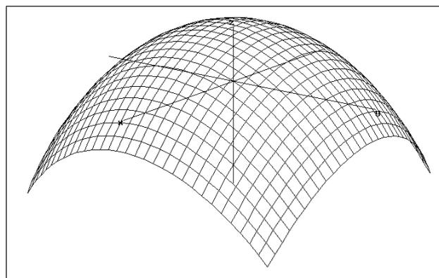
Abbildung 23.9.: Rotationsparaboloid
