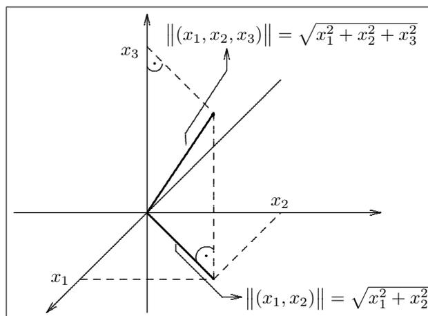
Abbildung 17.1.: Länge eines Vektors
