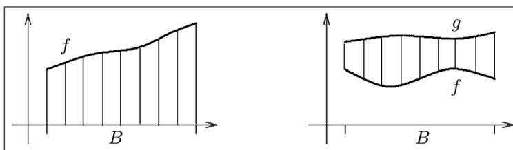
Abbildung 23.6.: Fläche zwischen Graphen bzw. zwischen Graph und Achse
